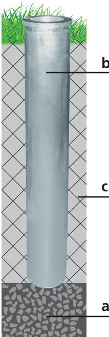
Mit der Original-Bodenhülse haben Sie die Garantie, dass der Mast einwandfrei verankert ist und senkrecht steht. Zudem kann der Mast jederzeit entfernt werden (wichtig bei Seilwechsel).
