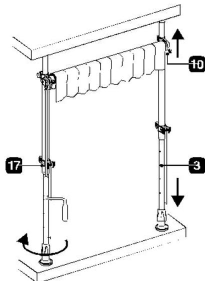
5. Fahren Sie die Markise mit der Handkurbel vollständig aus. Lösen Sie die Endschrauben vom Stützrohr 10 und verbinden Sie die Bewehrungsverbindung mit dem Stützrohr 10. Ziehen Sie die Endschrauben wieder fest. Lösen Sie die Schraube 17 vom Befestigungselement des Verstärkungsgelenks und bringen Sie die Markise in eine geneigte Position. Endschraube 17 wieder festziehen.
