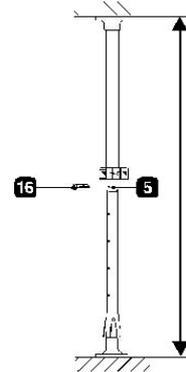
3. Ziehen Sie die Stützpfosten unter dem Balkon oder Dachüberstand heraus, ohne die Höhe anzupassen. Entfernen Sie die Deckenverschlüsse 15. Lösen Sie die Endschrauben der Befestigungselemente 2 und 13. Schieben Sie den oberen Stützpfosten in die Befestigungselemente und 13. Ermitteln Sie die ungefähre Höhe der Markise und ziehen Sie die Endschrauben wieder fest.
