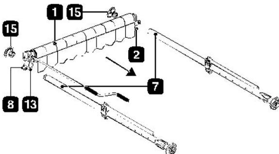
4. Verschließen Sie die oberen Stützpfosten wieder mit den Deckenverschlüssen 15. Stellen Sie die fertige Markisenkonstruktion aufrecht hin. Drehen Sie die Gewinde der unteren Stützpfosten 4 im Uhrzeigersinn, um die Markisenkonstruktion sicher zwischen Boden und Decke zu verkeilen. Stellen Sie sicher, dass der Stützpfosten sehr sicher ist, um Unfälle zu vermeiden.
