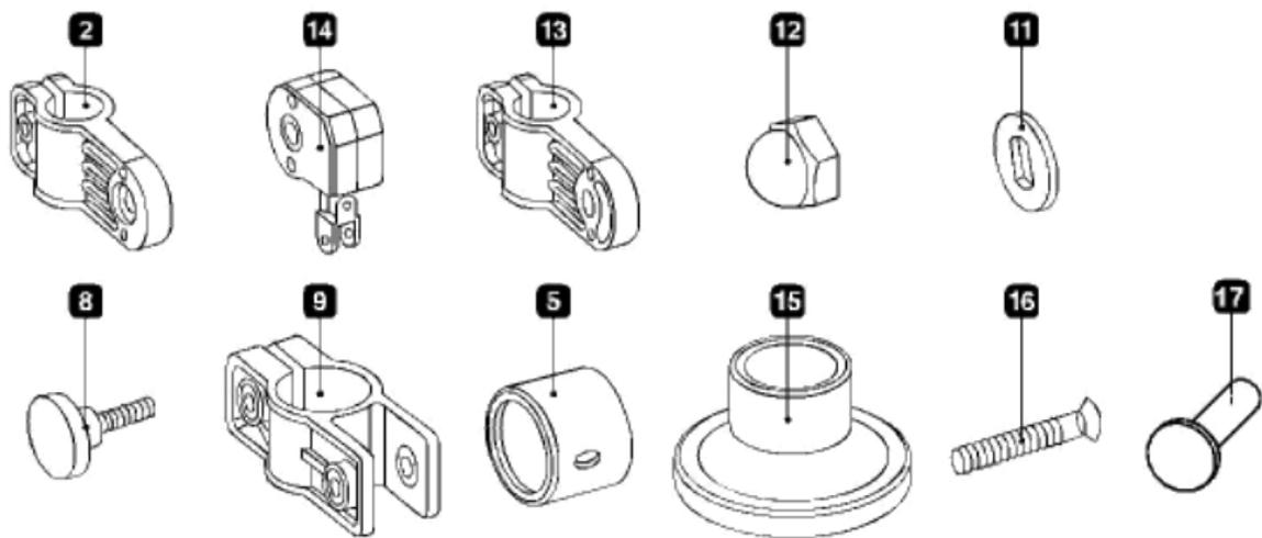
1. Stecken Sie den oberen Pfosten in den unteren Stützpfosten 4 und verschließen Sie den oberen Stützpfosten mit dem Deckenverschluss 15
