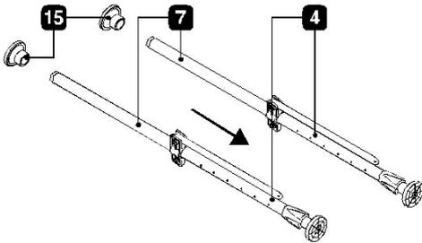
2. Stellen Sie die Stützhöhe entsprechend der verfügbaren Deckenhöhe ein. Schrauben Sie die Schraube 16 durch die vorgebohrten Löcher des unteren Stützpfostens in das Verriegelungselement ein, um die Stützhöhe zu sichern.
