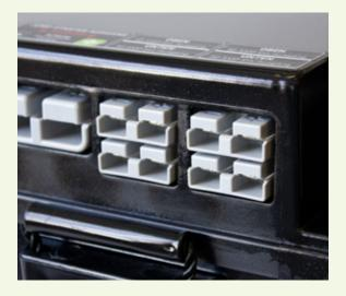
Bei allen Anschlüssen direktes Plug&Play Prinzip mit Anderson Stecker.
